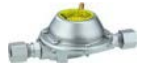
13 VORDRUCKREGLER TYP DE 50/30 S 0,8 kg/h, 30 mbar, bds. RVS8. Zur sicheren und normgerechten Integration von 30 mbar Gasgeräten in 50 mbar Flüssiggasanlagen in Fahrzeugen und Booten. 9955457 82,50
