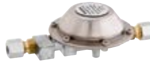
12 NIEDERDRUCKREGLER G76 (1,5 kg/h) Zum Anschluss von 30 mbar Caravans bzw. Motorcaravans (Reisemobile) an 50 mbar Standleitungen. Nur zur Verwendung im Freien geeignet! Nicht innerhalb von Fahrzeugen verwenden! Anschluss RVS 8 x RVS 8. 9952384 59,50
