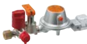
17 NIEDERDRUCKREGLER TYP EN61 PS 16 BAR Zum Anschluss für fest am Fahrzeug installierte Gasbehälter (z. B. Gastanks). Wahlweise mit Anschluss Komb. A. oder 2 x Schneidringverschraubung (RVS). Div. Innenteile Edelstahl. Gasdruck 50 mbar/1 kg/h. Anschluss Komb. A. x SKU/RVS 8 9952395 226,00 Ausführung mit Anschluss RVS 8 x SKU/RVS 8 9952464 226,00 (o. Abb.) Passt zu 9970397 Basic Control S 256
