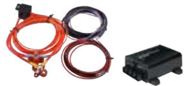
18 HOCHLASTRELAIS EBL MIT EINBAUSATZ BCB 30/40 Wird benötigt, wenn Power Pack Classic Power I + II und Power Pack Classic Power Plus I + II in Fahrzeugen parallel mit verbauter Basiselektronik oder mit Elektroblock (EBL) eingebaut wird. 9920679 185,00
